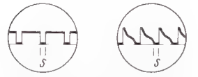
Bild 9. Meßschaltung und Stromkurven eines Wechselrichters. Links: Günstiger Schaltstromverlauf. Rechts: Ungünstiger Schaltstromverlauf, verursacht durch zu große kapazitive Last s = Schließzeit der Kontakte
